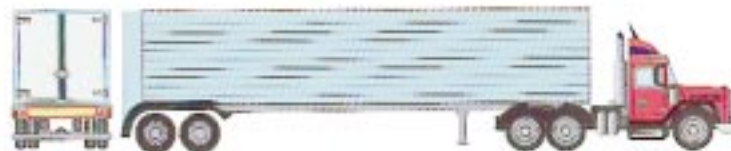
Vehículo corriente de caja. Puede contener cargas peligrosas mezcladas
