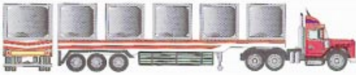
Contenedores espaciados para líquidos a granel
