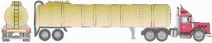
Cisterna para corrosivos
