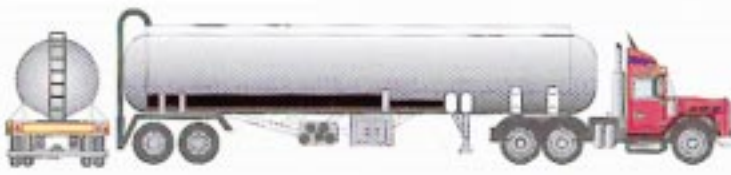
Cisterna para carga química, presurizada hasta 1,75Bars
