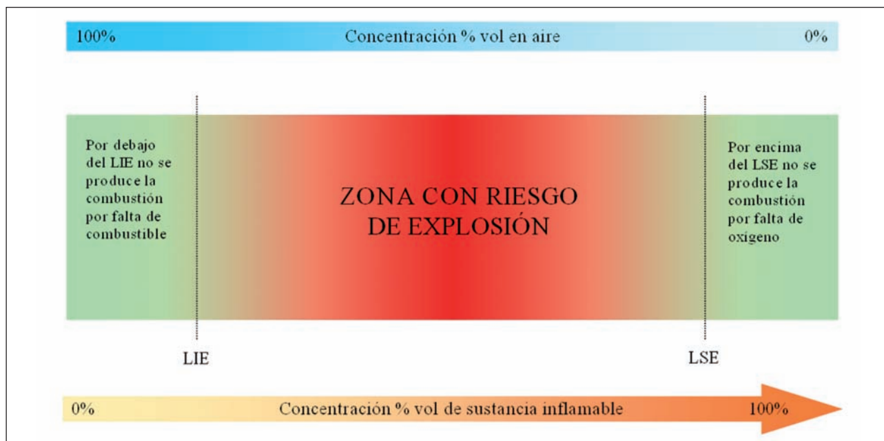
Figura 7 - Rango de explosividad de una sustancia inflamable.
