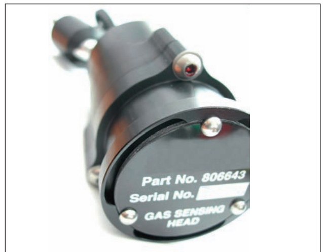
Figura 31 - Detector de gas.
