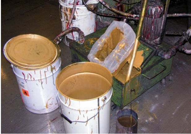
Figura 15 - Los recipientes que contengan sustancias inflamables deben estar convenientemente cerrados.
