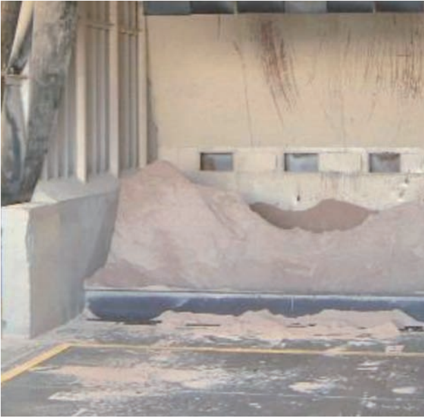
Figura 26 - La extensión de la zona clasificada por polvo debe extenderse a todas las áreas donde haya polvo depositado, ya que éste puede ponerse en suspensión.
